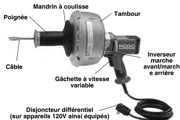
Figure 1 – Dégorgeoir K-45 avec mandrin à coulisse
