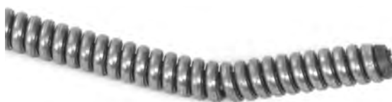
Figure 15 – Plissage de l'embout de câble
