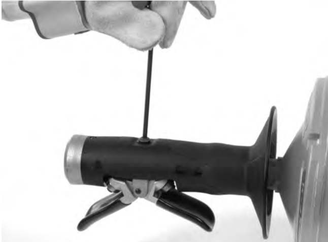
Figura 12A – Extracción del tornillo de la AUTOFEED
