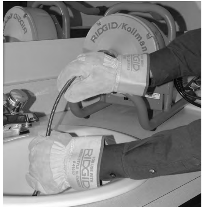
Figura 9 – Alimentación del cable en forma manual
