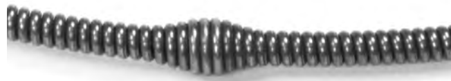
Figure 10 – Câble C-13-IC équipé du témoin de fin de course Speed Bump à environ 84 pouces de l'extrémité arrière du câble
